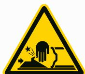
При закреплении обода следите, чтобы руки и детали не попадали между захватом и ободом!
