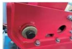
3. Протяните болт через опорное отверстие на стойке и отверстие вала цилиндра рычага заднего хода и затяните его самостопорящейся гайкой.
