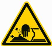
При закреплении обода следите, чтоб руки и детали не попадали между захватом и ободом!
