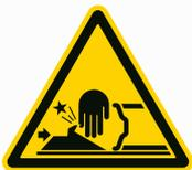
При закреплении обода следите, чтоб руки и детали не попадали между захватом и ободом!
