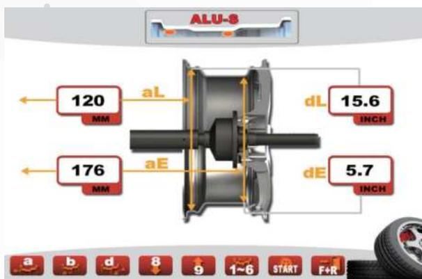
Подтяните автоматическую линейку к точке крепления aL и придержите ее на внутренней стороне шины. Требуемые значения aL и dL будут введены автоматически и станут красными; либо нажмите клавишу "a" для выбора aL и клавиши "8" и "9" для ввода значения aL; нажмите клавишу "d" для выбора dL и клавиши "8" для ввода значения aL и клавиши "9" для ввода значения dL.
