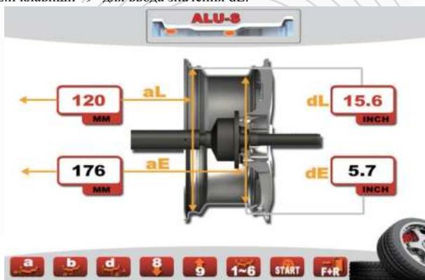
Подтяните автоматическую линейку к точке крепления aE и придержите ее на внутренней стороне шины. Требуемые значения aE и dE будут введены автоматически и станут красными; либо нажмите клавишу "a", чтобы выбрать aE, и клавиши "8" и "9", чтобы ввести значение aE; нажмите клавишу "d", чтобы выбрать dE, и клавиши "8" и клавиши "9" для ввода значения dE.
