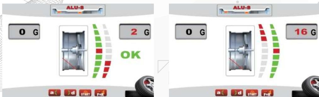
На дисплее исходный дисбаланс разделен на две части. Установите балансировочный груз в соответствии с теми же методами, что и для установки перед разделением.
