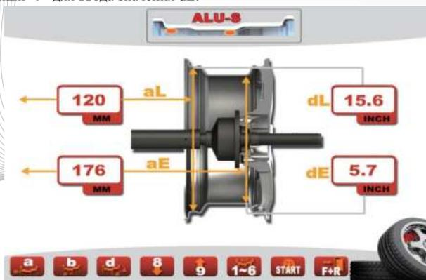
Нажмите кнопку "ПУСК" или опустите защитную крышку, чтобы запустить двигатель. После расчета на дисплее отобразится значение.
