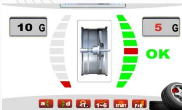
После фиксации шины установите балансировочный груз соответствующего веса в самой высокой точке (положение на 12 часов) на внутренней или внешней стороне диска, как показано на рисунке.
