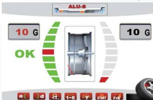
Медленно поверните шину вручную или нажмите клавишу "O/R", чтобы шина автоматически повернулась до точки внешнего дисбаланса. В этом случае в нижней части появится надпись [OK], блокирующее устройство автоматически зафиксирует шину, а лазерный указатель автоматически наведет лазер на точку дисбаланса.
