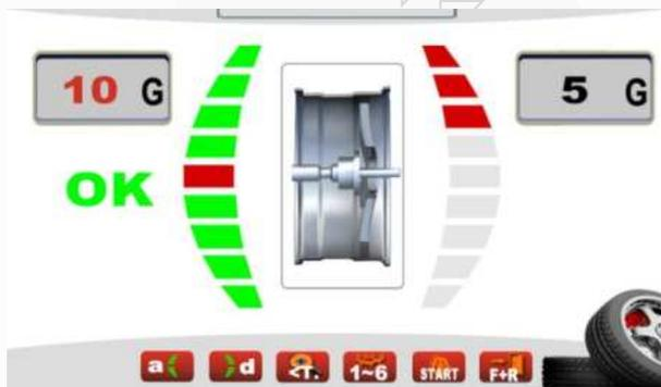
Медленно поверните шину вручную или нажмите клавишу "O/R", чтобы шина начала автоматически поворачиваться до тех пор, пока точка ее внутреннего или внешнего дисбаланса не окажется прямо над ней (положение на 12 часов). В этом случае в нижней части появится надпись [OK], и блокирующее устройство автоматически заблокирует шину.
