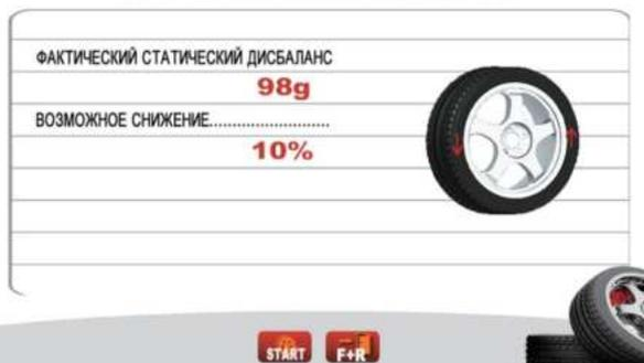
Медленно поверните шину, найдите точки дисбаланса шины и спицы соответственно и отметьте их. С помощью шиномонтажного стенда совместите отметки друг с другом и установите шину и спицу. Выровняйте шину на балансировочном устройстве.
