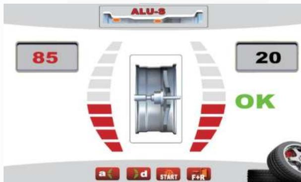
Закрепите направляющий блок необходимым грузом на головке измерительного устройства, потяните линейку в положение, показанное на рисунке (до тех пор, пока не раздастся звуковой сигнал), плотно прижмите головку измерительного устройства к ступице и нажмите на направляющий блок, чтобы он плотно прилегал к ступице.
