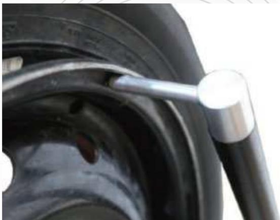
После того как значение "b" стабилизируется и станет красным, уберите линейку, и значение "b" будет автоматически считано системой и станет белым.
