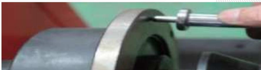
Выполните операцию в соответствии с инструкциями на дисплее и нажмите клавишу "3", чтобы войти в подменю калибровки измерительного устройства d. Плотно прижмите головку измерительного устройства к передней части фланца, как показано на рисунке. Нажмите клавишу "b" еще раз для подтверждения.
