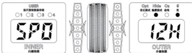
4. Отобразите окно 1, вручную поверните колесо, чтобы найти первое неравномерное положение снаружи, выведите на экран таблицу 2, чтобы прикрепить балансировочный блок, и продолжайте вращать колесо, чтобы найти второе неравномерное положение снаружи, выведите на экран окно 3, чтобы прикрепить балансировочный блок.
